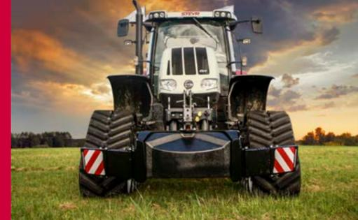
Der Überfahrerschutz lässt sich schnell und einfach an den Schlepper ankuppeln. Das ist sowohl am Oberlenker als auch an einem A-Rahmen möglich. Die Breite der Sicherung kann von 220 bis 295 cm variabel eingestellt werden. Sie können die Ausführung des Überfahrerschutzes an die Spezifikationen Ihres Schleppers anpassen, so dass es eine logisch aufeinander abgestimmte Einheit wird.
